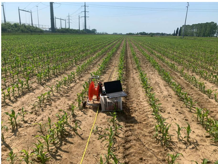
*Foto n° 2: Stendimento sismico con acquisizione MASW 1.*
