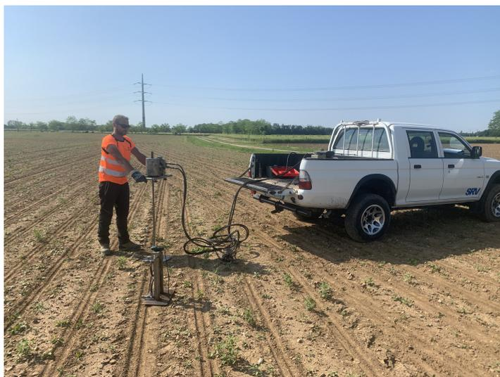
Foto n° 1: Attrezzatura utilizzata per le prove penetrometriche (DIN5).
